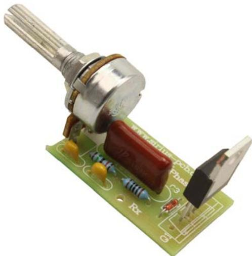
Устройството може да се използва като регулатор на обороти за дрелка, вентилатор, регулатор за осветление и други консуматори, захранващи се от електрическата мрежа 220V. Схемата е реализирана с триак и диак, което позволява двупериодно регулиране със загуби до 3% и КПД 97%.
