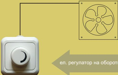
Промишлените вентилатори серия ПВО могат да бъдат снабдени с електронен регулатор на обороти, като оборотите могат плавно да се изменят или регулират в границите от  $900\text{ min}^{-1}$  до  $2600\text{ min}^{-1}$  за двуполюсните модели и от  $500\text{ min}^{-1}$  до  $1400\text{ min}^{-1}$  за четириполюсните. Това позволява регулиране на дебита и нивото на шум на вентилатора, в зависимост от променящите се нужди на потребителя.
