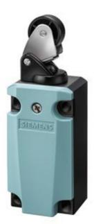
SIRIUS POSITION SWITCH METAL ENCLOSURE 40MM ACC. TO EN50041 DEVICE CONNECTION 1X (M20X1.5) 1NO/1NC SNAP-ACTION CONTACTS METAL ROLLER LEVER AND PLASTIC ROLLER 22MM
