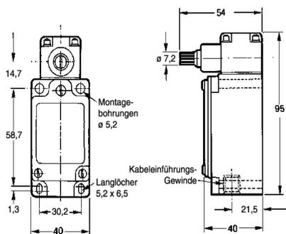
**Schaltvermögen:** 10 A 120 V~ 240 V~ 480 V~
