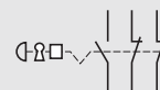
Styki przycisku grzybkowego awaryjnego zatrzymania, przekręcane w celu zwolnienia, z kluczem języka spustowego typu N/O+2N/C
