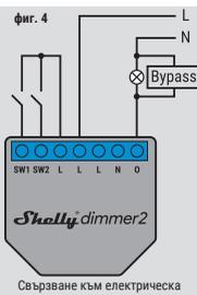
Свързване към електрическа мрежа без неутрален кабел, без минимално потребление и използване на Shelly Bypass
