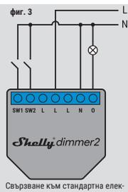
Свързване към стандартна електрическа мрежа с неутрален кабел и ключове, също свързани към неутрална.
