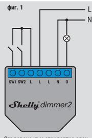
Свързване към стандартна електрическа мрежа с неутрална
