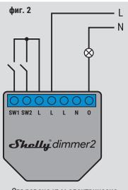
Свързване към електрическа мрежа без неутрален кабел
