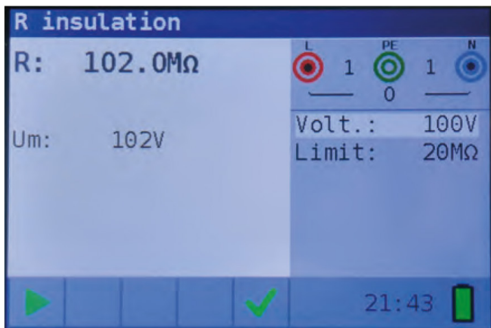
Фиг. 4.3: Пример за резултати от измерване на изолационно съпротивление
