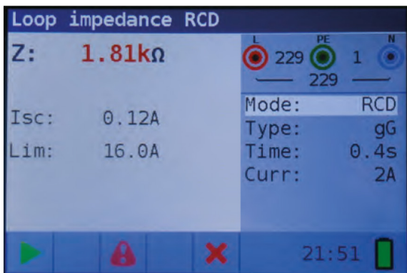
Фиг. 4.25: : Пример за резултати от измерване на импеданса на контура с функция Trip-Lock
