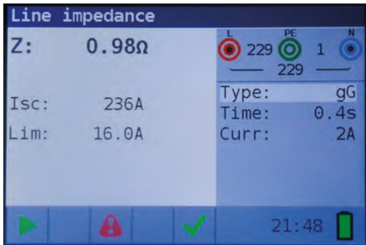
Фиг. 4.28: Пример за резултати от измерване на импеданс на линия
