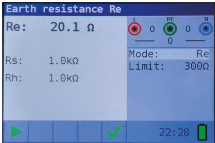
Фиг. 4.38: Пример за резултати от измерване на заземително съпротивление
