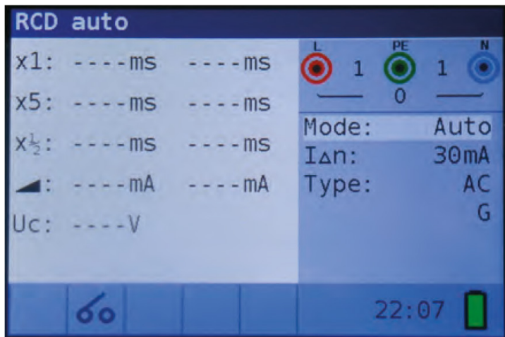
Фиг. 4.18: Меню за автоматичен тест на RCD
