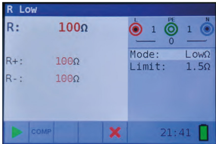
Фиг. 4.7: Примери за резултати от измерване на ниско съпротивление (R Low)
