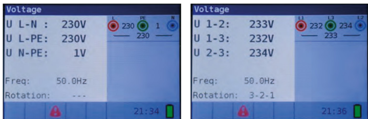
Фиг. 4.34: Примери за измервания на напрежение и честота
