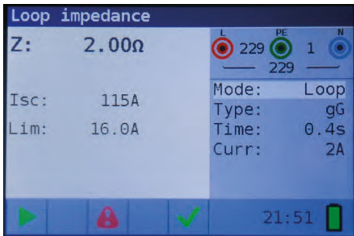
Фиг. 4.23: Пример за резултати от измерване на импеданс на контура
