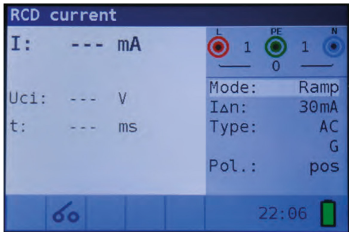
Фиг. 4.16: Меню за измерване на ток на изключване
