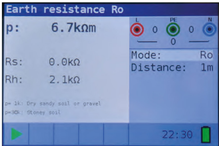
Фиг. 4.41: Пример за резултати от измерване на специфично заземително съпротивление
