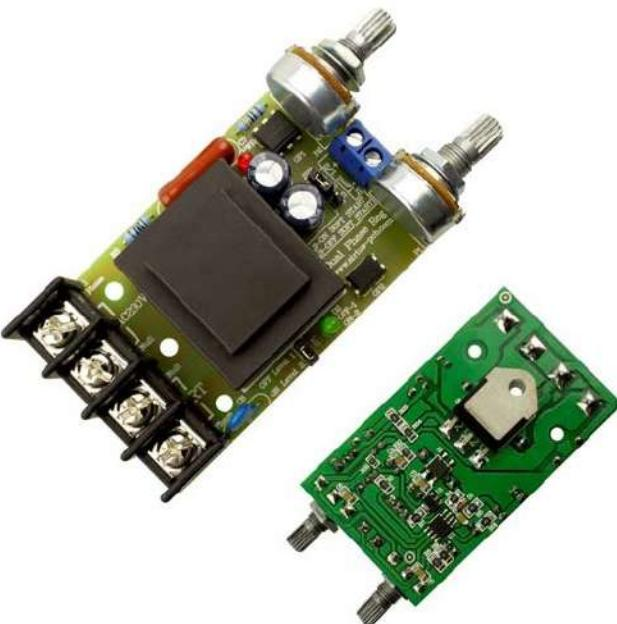
Устройството е изградено на базата на съвременен микроконтролер и е предназначено за регулатор на обороти за дрелка, вентилатор, регулатор за осветление, нагревател и други консуматори, захранващи се от електрическата мрежа 230V.
