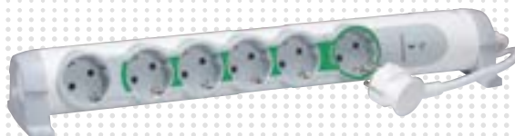
реф. 694648 "Master and slave" разклонител. Изключването на уреда в първото гнездо поставя в "stand by" и уредите включени в следващите 4 гнезда (индикирани са в зелен цвят). 6-тото гнездо е независимо от останалите.
