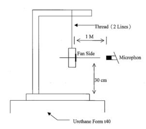
1 METER FROM MICROPHONE TO FAN INTAKE
