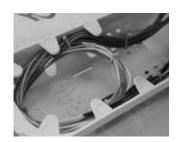
6.3 Удалите защитную прозрачную крышку. После того, как выполнена разделка кабеля и оптических модулей, установите кассету тип 2533 на нижнюю часть каркаса муфты.
