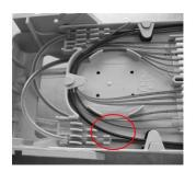
7.2.5 Установите на кассету прозрачную крышку. После монтажа всех кассет вставьте силовой элемент через кромку кассеты.
