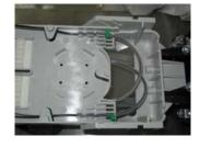
7.3.2 Надвиньте термоусаживаемую защитную гильзу сростка оптических волокон на первое свариваемое оптическое волокно. Сварив оптические волокна, усадите поверх сварного соединения оптических волокон термоусаживаемую защитную гильзу сростка.
