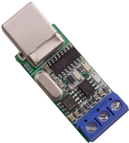
Устройството USB to RS485 rev.1 служи за осъществяване на връзка между компютър чрез USB порт и устройства с комуникационен канал RS485. Системата позволява включването на няколко интерфейсни контролера към един управляващ компютър. Устройството е базирано на чипа CH340G и MAX485.
