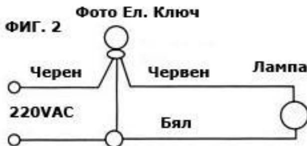
На ФИГ.2 е показана схема на свързване на фотоелектричният ключ при употреба на осветление с нажежаема жичка.
