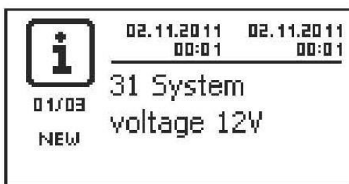
Фиг. 5: Съобщение събитие с засечено системно напрежение (в примера: 12V)
