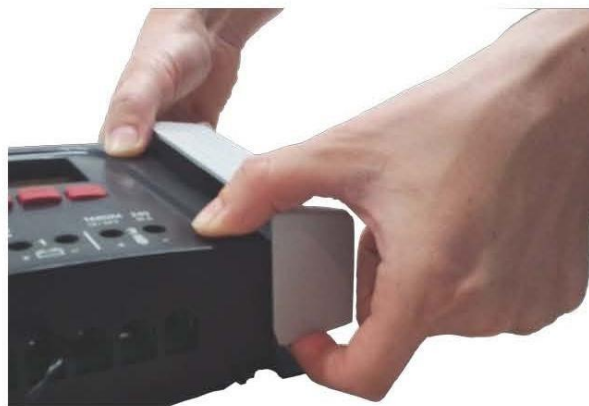
Фиг. 3: Освобождаване на капака от крайно положение (тук – десен капак)
